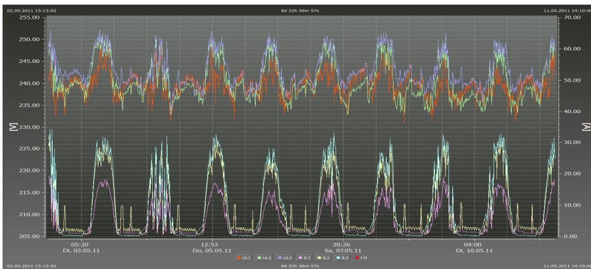
Spannung, Strom 3-phasig
